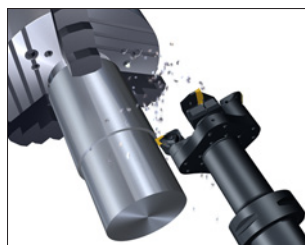
Torneado con eje B a 0°. Buena alternativa cuando la máquina tiene limitada la carrera en el eje X.
