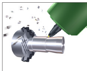
Torneado lateral y copiado con plaquitas DNMG.
